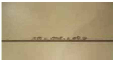
Obr. 2: Stav zkušební vzorku po provedení 12 cyklů. Když vozík dokončil 450 otáček, zkušební vzorek se podrobí vizuálnímu zkoušení s cílem zjistit, zda 13. cyklus bude zahájen. (foto Bill Griese)
