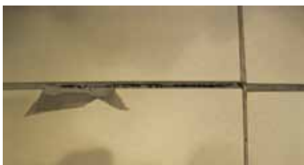
Obr. 2: Stav zkušební vzorku po provedení 12 cyklů. Když vozík dokončil 450 otáček, zkušební vzorek se podrobí vizuálnímu zkoušení s cílem zjistit, zda 13. cyklus bude zahájen. (foto Bill Griese)
